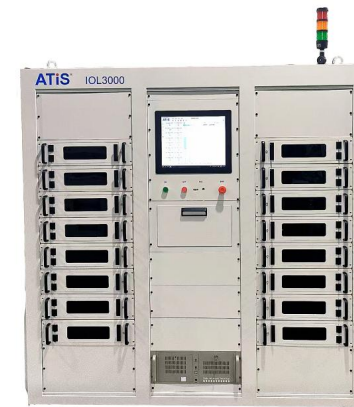
➤ 分立器件IOL寿命试验
